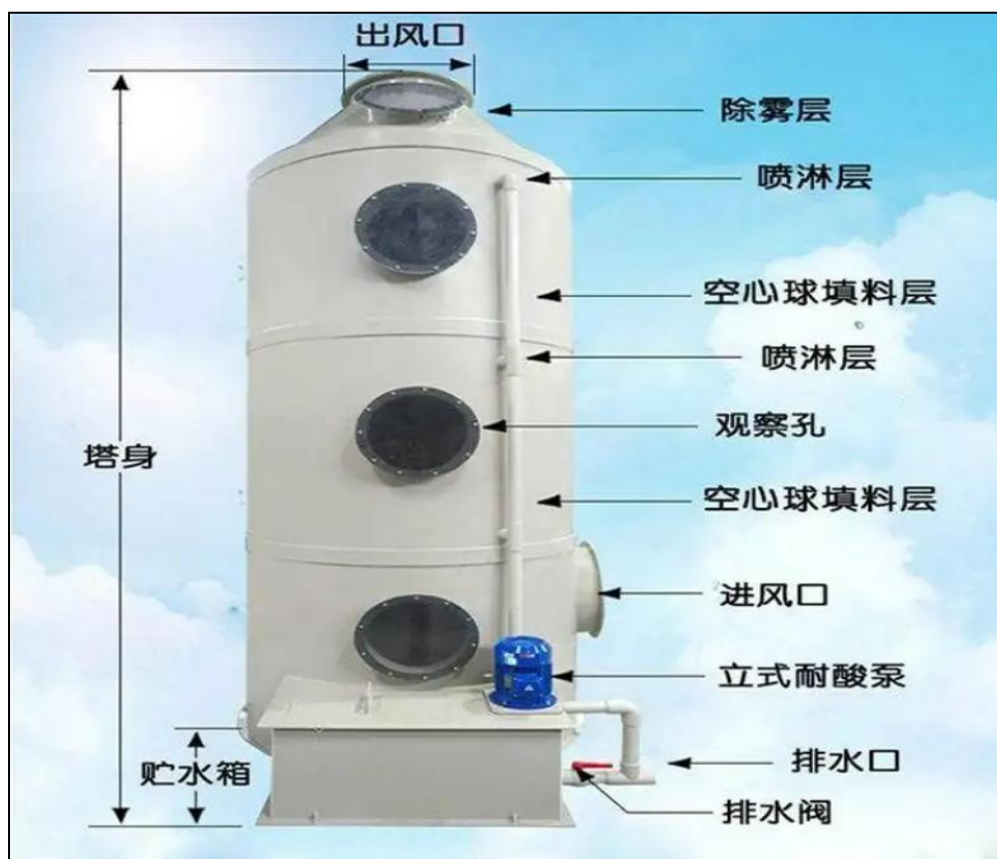
图 6-2-2 本工程碱液喷淋塔结构示意图
