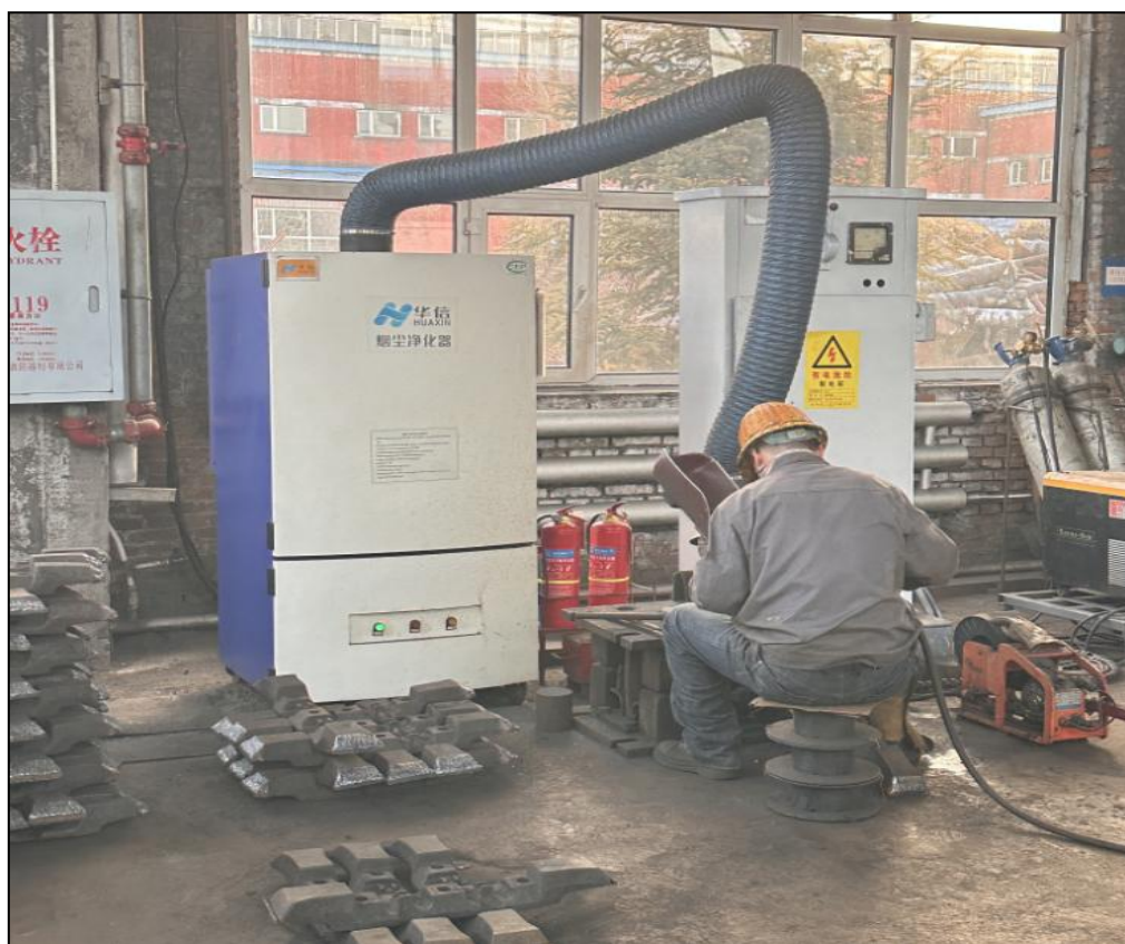
图 6-2-9 本工程移动式烟尘净化器实际样式示意图
